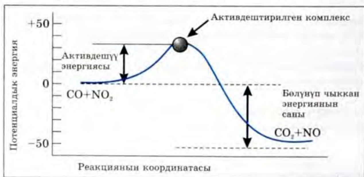
10-сүрөт. \text{CO} + \text{NO}_2 \rightarrow \text{CO}_2 + \text{NO} реакциясы үчүн потенциалдык энергиянын диаграммасы.
