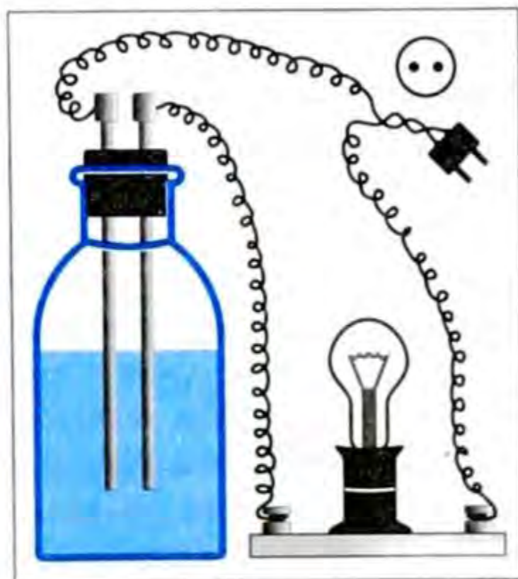
8-сүрөт. Эритмелердин электр агымын өткөрүүсүн текшерүүчү курал.
